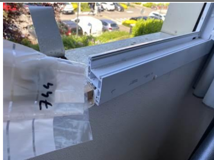
Photo n° PhA744 Localisation : 1er étage - L122 - Chambre Ouvrage : Isolant entre menuiseries et ITE Description : Fibres isolantes Localisation sur croquis : 744 Amiante : Non détecté
